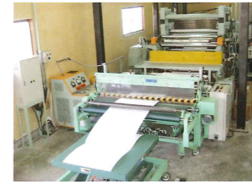
パンチング・ラミネート・アニーリング自動カット機
